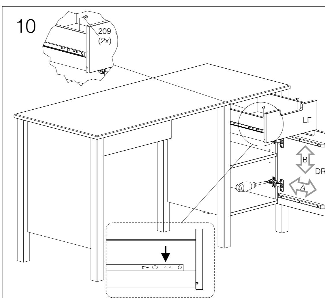
A. Deze schroef gebruiken wanneer u de kieren tussen de deuren en beide zijden groter of kleiner wilt hebben.
