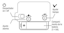
Desactivar/activar la función de despertador en el interruptor de encendido/apagado.
